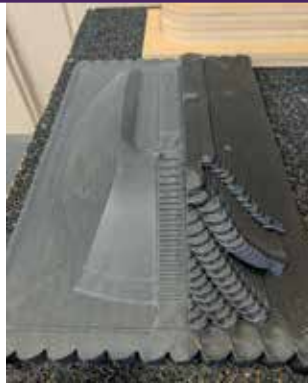
一个采用 Thermwood LSAM 打印和部分修整之后的零件在不同阶段的样子。
