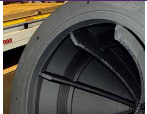
上图是与美国海军水面作战中心合作开发的一艘潜艇的非机密级机头。这一部分用了 11 小时 45 分钟打印出来。修整部分又花了 5 个小时。
