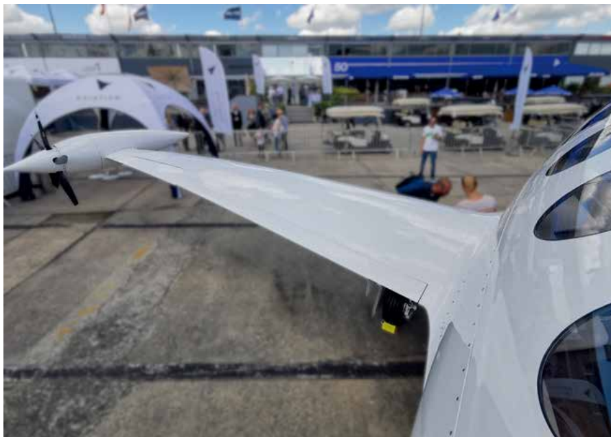
Alice Wing 在 2019 巴黎航展上。采用灌注技术制造了完整的复合结构。
