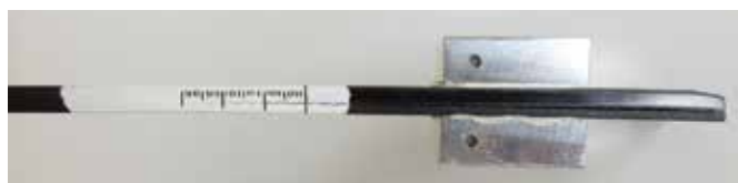
图 4：COGIT 专门设计的二次成型 G1c 试样（原材料：碳/PEKK）。
