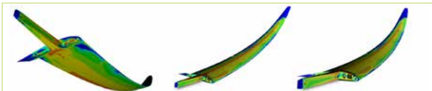
图 5：Ansys Composite PrepPost 可用于分析复合材料机翼的安全系数。翼弦中心的安全系数最低(橙色)，这是由该区域的翼梁边缘受压所致。
