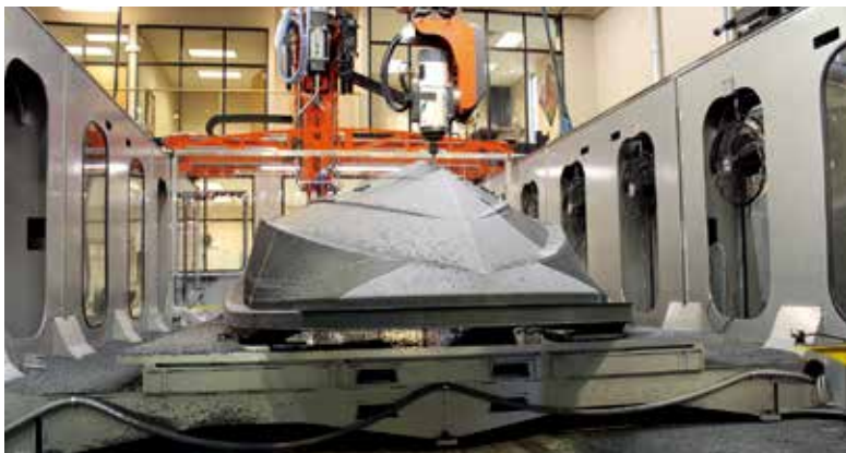
在 Thermwood 10'x20' LSAM 设备上修整一个由 ABS 制成的船壳。整个打印、组装和裁剪过程甚至不到 10 个工作日。
