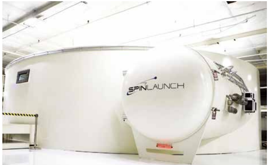
SpinLaunch 在其位于 Sunnyvale 的前总部建造了第一台 12 米离心机样机。
