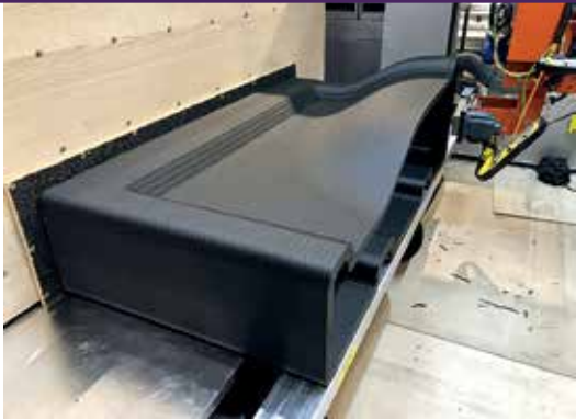
通过 VLP (垂直层打印) 打印出的零件图像。这种方法可以轻松打印出很长的零件。
